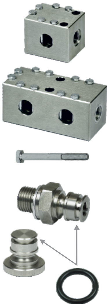
Beispiel Verteilerleistenkombination kpl. PN250 - DN8 - 7x DN2 Steck - G1/4i, bestehend aus Art.Nr. 2000032, 2000030, 0009878, 0005816
